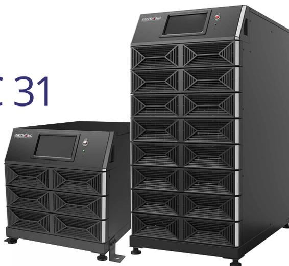
Устройства серии МУЛЬТИПЛЕКС 31 – это модульные ИБП с однофазным выходом, которые могут быть сконфигурированы с 6 модулями питания (максимум 20 кВА), 5 группами аккумуляторных модулей и дополнительным модулем зарядки на 10 А. Совместимы со всеми видами 19-дюймовых стандартных шкафов. Это решение особенно подходит для небольших и средних серверных помещений.
