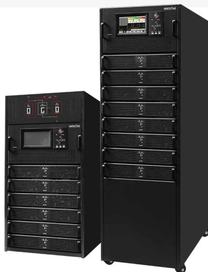
Серия ИБП МУЛЬТИПЛЕКС – это масштабируемая система, выполненная по технологии двойного преобразования, с возможностью горячей замены модулей. Мощность системы варьируется от 25 до 300 кВА/кВт, что делает ее идеальным выбором для современного дата-центра. В силовых модулях используется новейшая трехуровневая IGBT-технология и технология полного DSP контроля, что делает систему МУЛЬТИПЛЕКС лучшей комбинацией надежности и гибкости.
